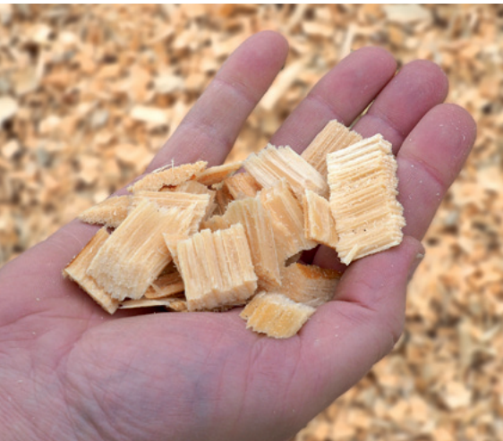
Perfekte Hackgutqualität der Fraktion 3 bei der Ziegler Holzindustrie durch die Andritz Iggesund-Spanerscheibe
