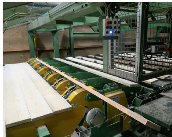
Der patentierte Framtec-Hochleistungszuteiler des Typs TongLoader bei Stallinger in Frankenmarkt (bis 210 Bretter pro Minute)
