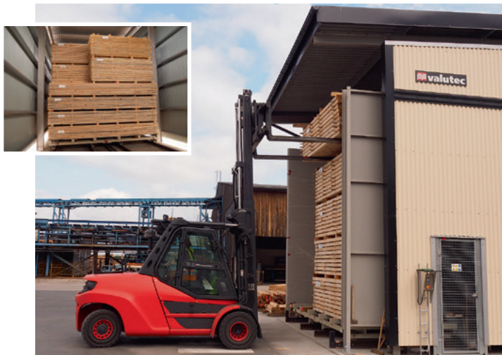
Beladung des Kanaltrockners von Valutec – auch unterschiedliche Dimensionen in einer Charge sind kein Problem (kl. Bild)
