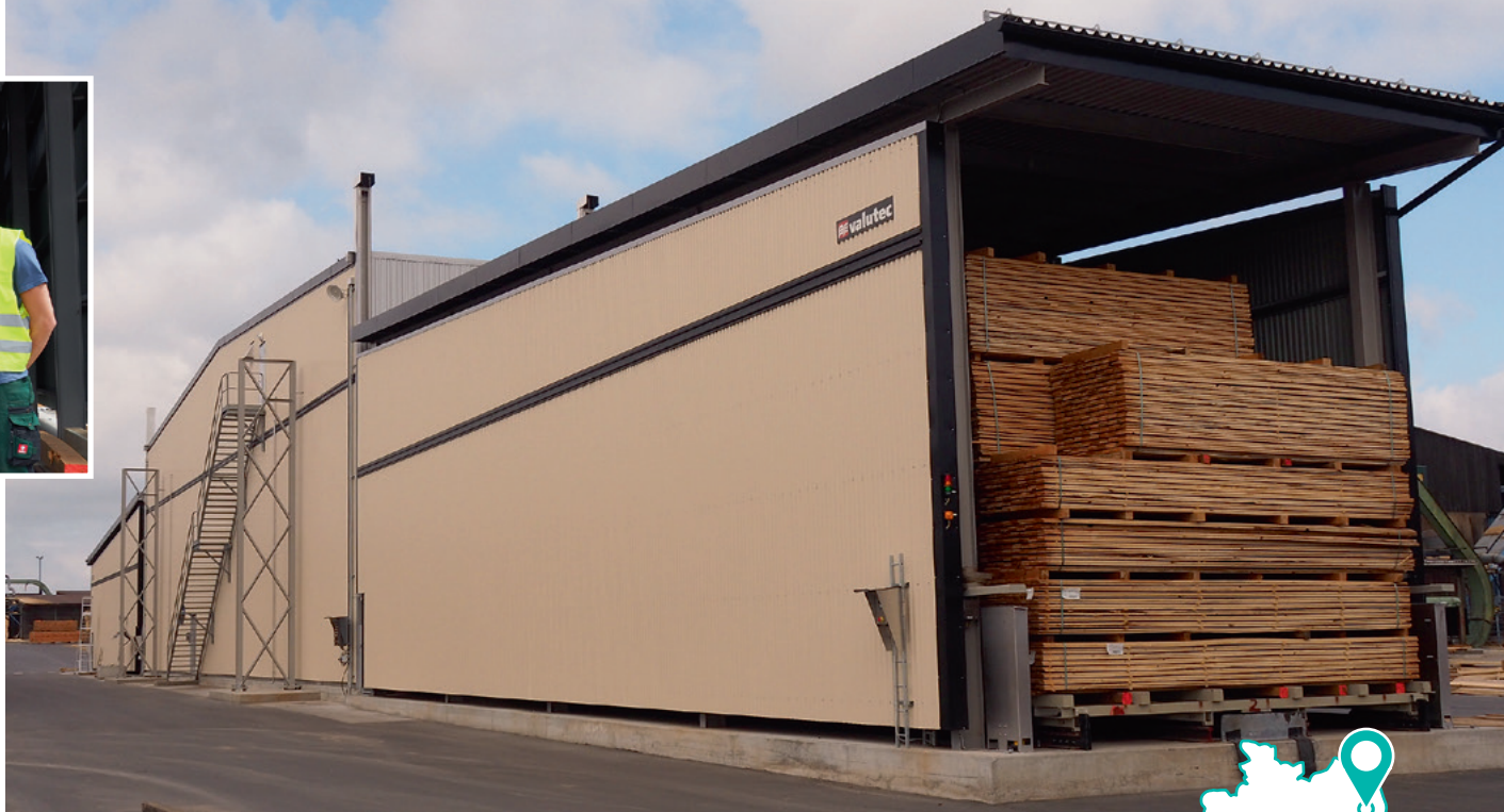
Imposant: 93 m misst der OTC-Kanaltrockner von Valutec bei Robeta, rechts die Abnahme der trockenen Ware
