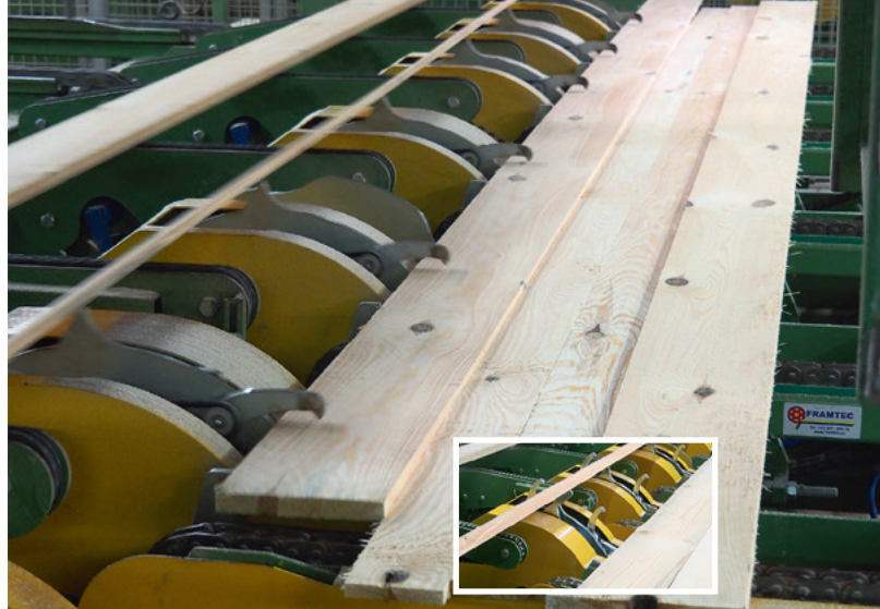
Kaum mit freiem Auge zu sehen: Der TongLoader erreicht in Kodersdorf dimensionsabhängig Spitzenleistungen von bis zu 210 Brettern pro Minute
