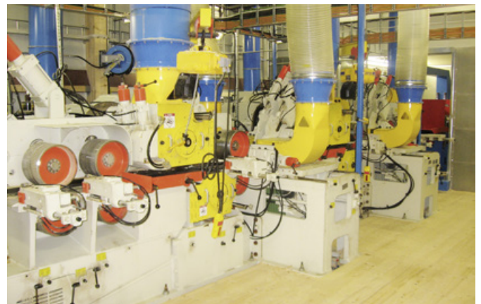
Diese 10-Wellen-Hochleistungsmaschine mit einem Vorschub von bis zu 1000 m/min ist seit 2007 bei Vida in Schweden im Einsatz
