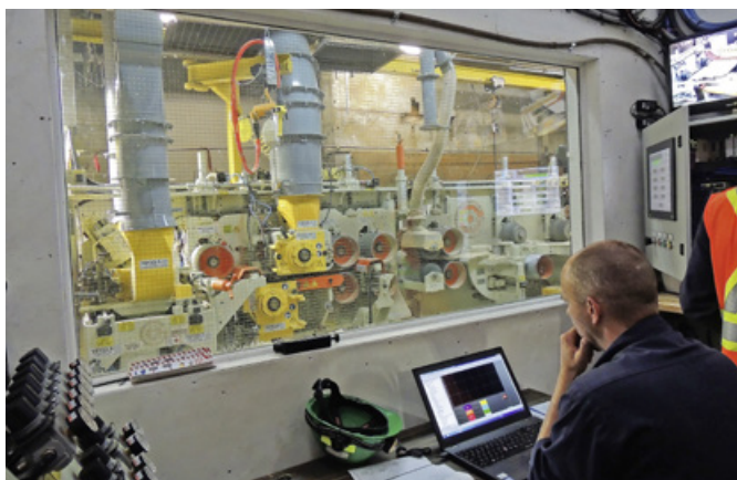
Die Gilbert-Hobelmaschine der S-Serie bei Resolute Forest Products schafft bis zu 550m/min
