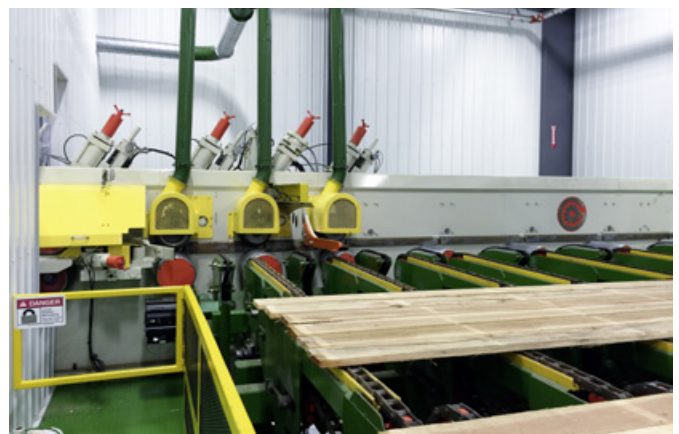
Der Gilbert-Hobeinzug besticht mit der betriebs sicheren Pull-Through-Technologie und kompakten Bauweise
