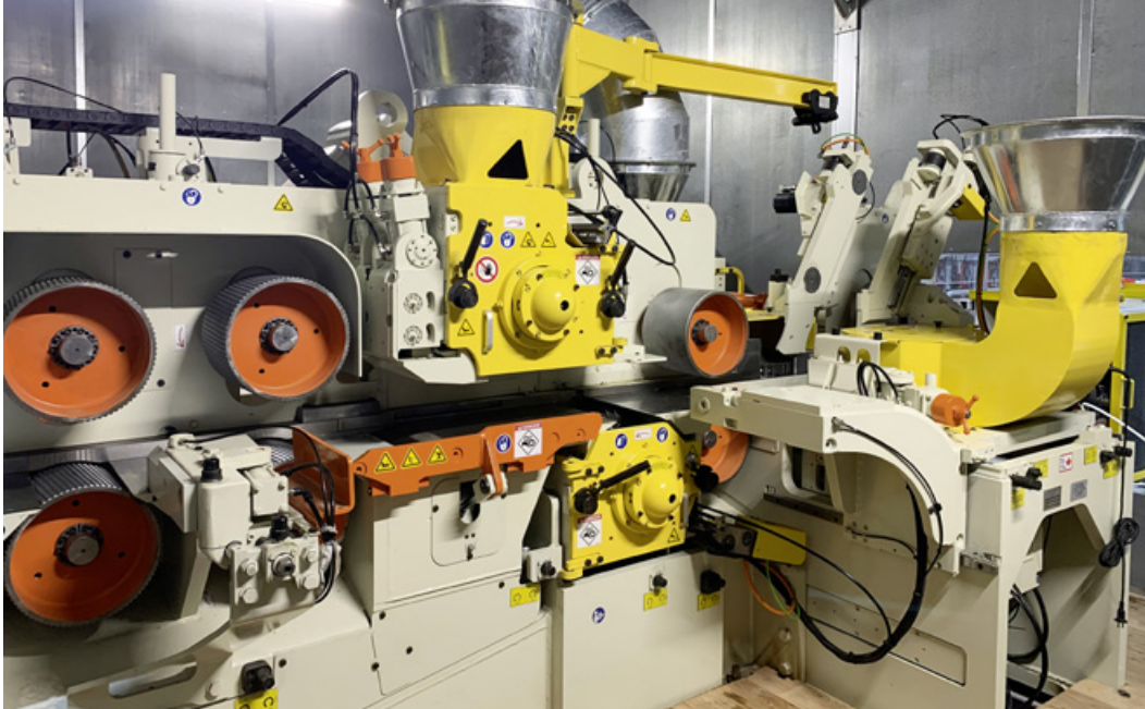
Die Hochleistungs-Hobelmaschine des Typs High Speed installierte Gilbert 2019 bei Mercer Timber Products in Friesau – die Vorschubgeschwindigkeit reicht bis zu 1200 m/min
