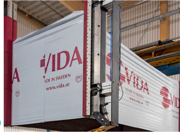
Servogesteuerte Aufspannung im Detail
